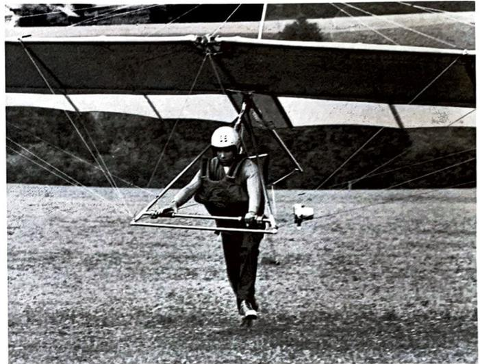
Fledge 2 bei der Landung. Deutlich zu erkennen die Drehgriffe für die Seitensteuerung.
